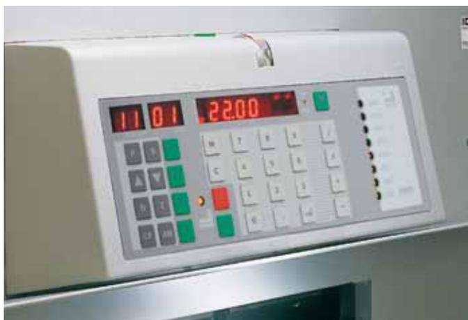
**ELEKTRONISCHES STEUERUNGSMODUL** Programmsteuerung für den elektrischen Rückanschlag (99 Programme mit je 99 Programmschritten).
