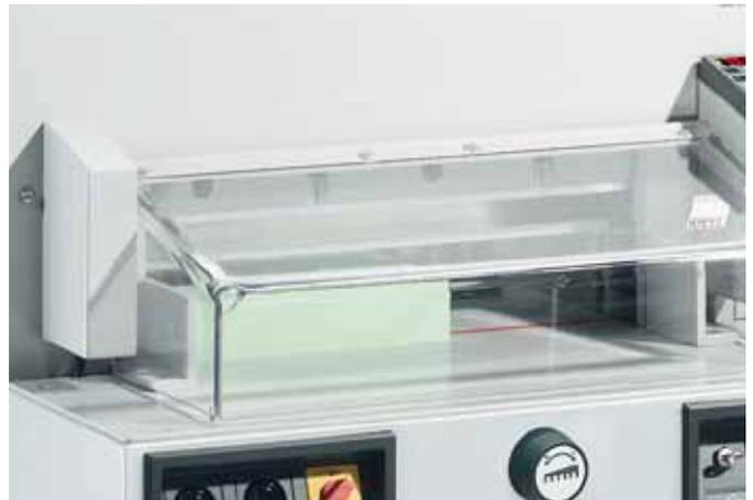
**SICHERHEITSSABDECKUNG** Die vordere, elektronisch kontrollierte Sicherheitsabdeckung lässt sich bequem nach oben aus dem Arbeitsbereich schwenken.
