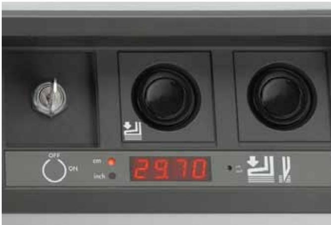
**DIGITAL-MASSANZEIGE** Gut ablesbar angebracht und per Knopfdruck umschaltbar von cm auf Zoll ist die Digital-Maßanzeige für ein präzises Positionieren des Rückenschlags.
