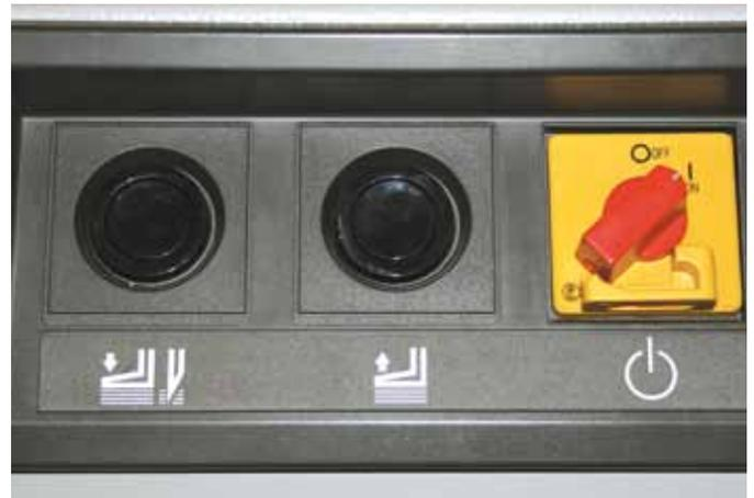
**DRUCKTASTER** Die automatische Pressung lässt sich auch unabhängig vom Messer über die entsprechenden Drucktaster heben und senken.
