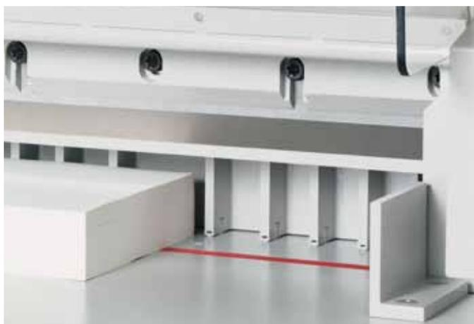
**PRÄZISE ANSCHLÄGE** Je zwei Seitenanschlätze auf dem Vorder- und Rücktisch sowie der präzise Rückanschlag mit enger Teilung ermöglichen exaktes Schneiden.
