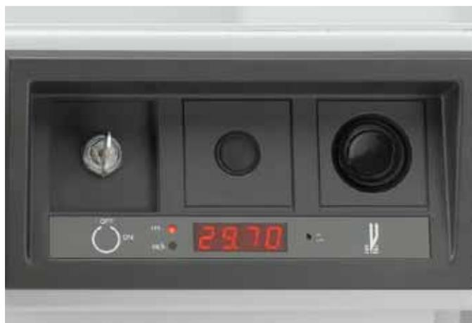
**DIGITAL-MASSANZEIGE** Der Rückanschlag lässt sich durch die Digital-Maßanzeige präzise per Handkurbel positionieren. Die Maßangabe ist umstellbar von cm auf inch.
