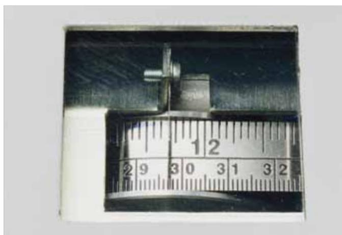
**MASSKALA** Die präzise Maßskala für die Positionierung des Rückanschlags ist gut ablesbar am Vordertisch dieses Stapelschneiders angebracht.
