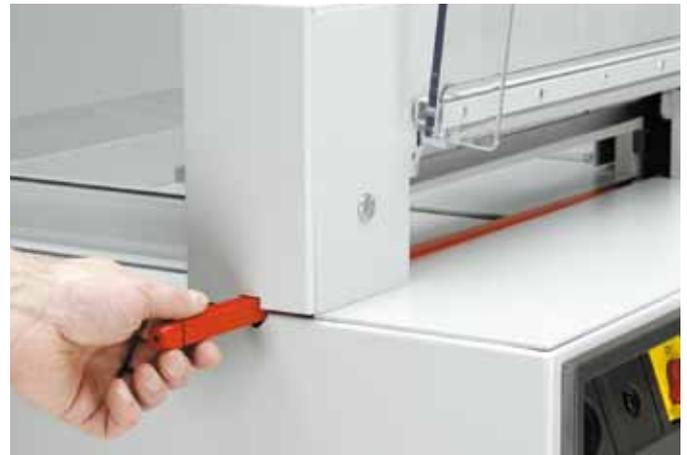
**SCHNITTLISTENWECHSEL** Das Drehen oder Austauschen der Schnittleiste ist einfach und bequem seitlich an der Maschine möglich, ohne in den Schneidebereich eingreifen zu müssen.
