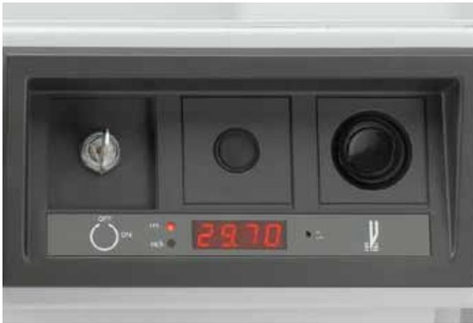
**DIGITAL-MASSANZEIGE** Gut ablesbar angebracht und per Knopfdruck umschaltbar von cm auf Zoll ist die Digital-Maßanzeige für ein präzises Positionieren des Rückanschlags.
