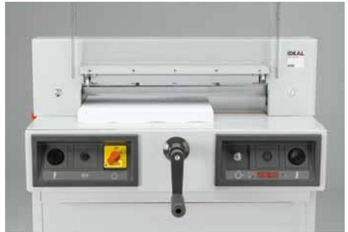
**AUTOMATISCHE PRESSUNG** Über die beiden Drucktaster der Bedienelemente wird per Zweihandbedienung ein Schnitt ausgelöst. Messer und Pressbalken werden gleichzeitig aktiviert.
