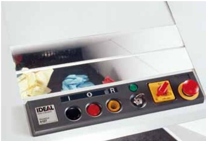
**BEDIENFELD** Ergonomisch angeordnetes Bedienpult mit Drucktastern für Vorwärtslauf/Stop/Rückwärtslauf und Kontrollleuchten für den Betriebsstatus der Aktenvernichter.
